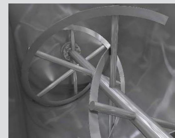
Special wear-resistant and corrosion-resistant coating on spindle and screw belt Specjalna powłoka odporna na zużycie i korozję na wrzecionie i pasie ślimakowym
